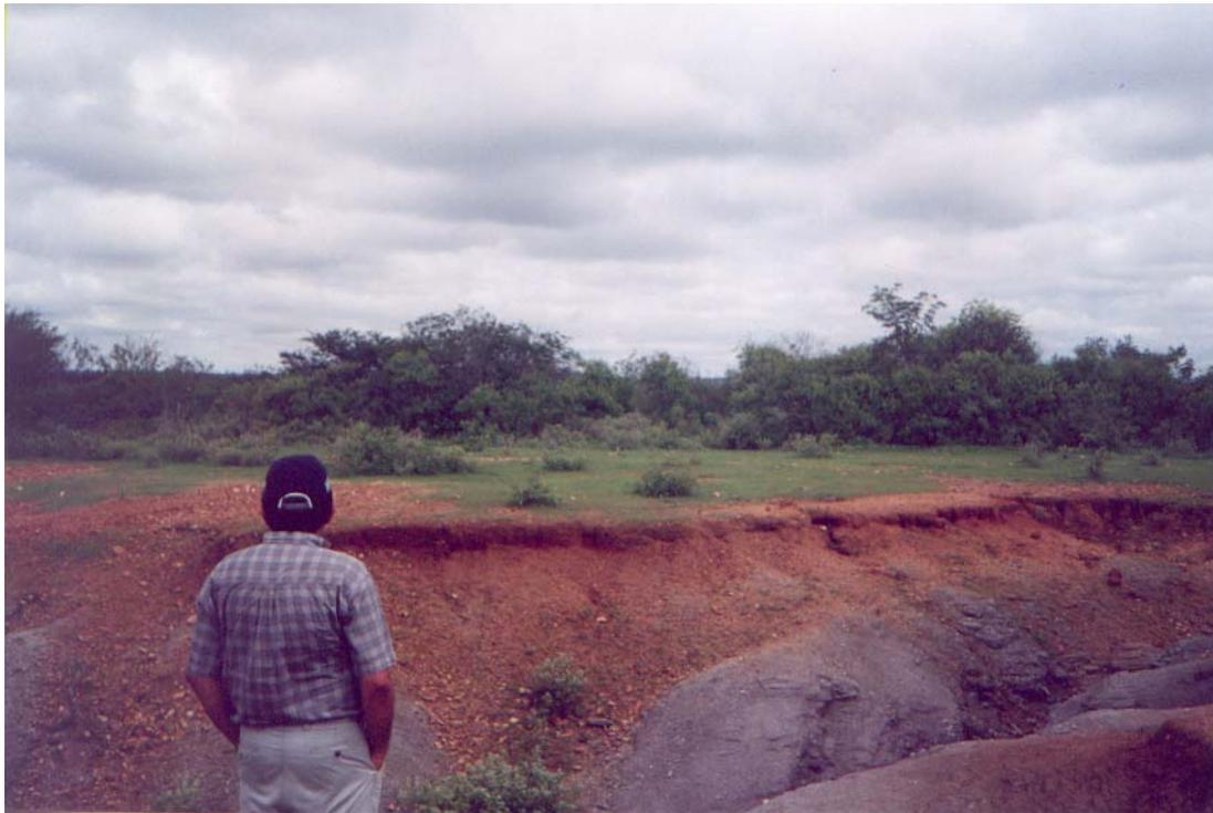
FOTO 9 - Detalhe da Foto 8, mostrando solo coluvionar com boas características para material de empréstimo, localizado a cerca de 4 km a montante do eixo.
